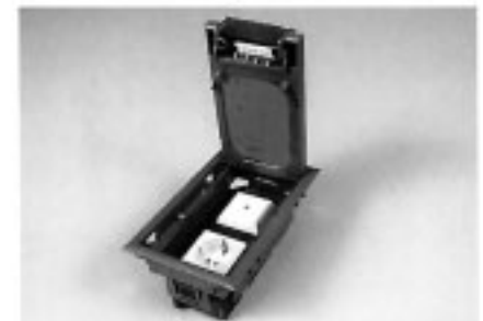
Einbaueinheit mit 1er Steckdose und Telefonanschluss, bündig mit der Oberfläche des Messebodens, Kunststoff grau. Aus- schnittmaß 181x105 mm. Wird als Bau- kasten angeliefert, keine Vormontage.
