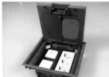
Einbaueinheit mit 3er Steckdose und 1 - 2 Telefonan- schlüssen, bündig mit der Oberfläche des Messebodens, Kunststoff grau. Aus- schnittmaß 201x201 mm. Wird als Bau- kasten angeliefert, keine Vormontage.
